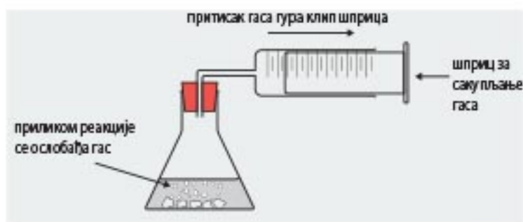
Апаратура потребна за мерења брзине реакције преко мерења запремине ослобођеног гаса.
