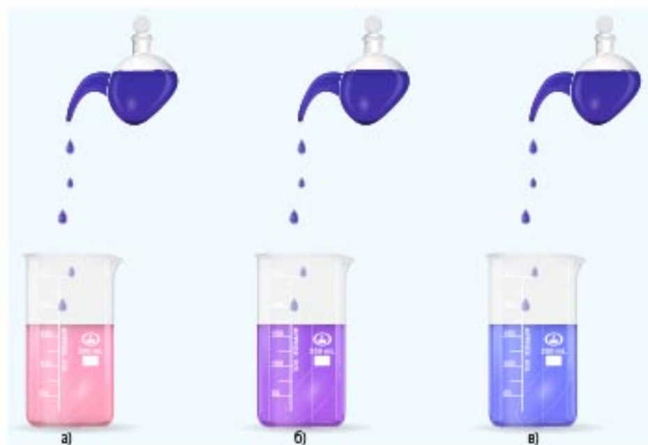
Лакмус мења боју у зависности од киселости средине: црвено-розе у киселој (а), љубичаста у неутралној (б) и тамноплава у базној средини (в).
