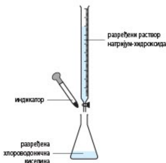
Титрација хлороводоничне киселине са натријум-хидроксидом у присуству индикатора.
