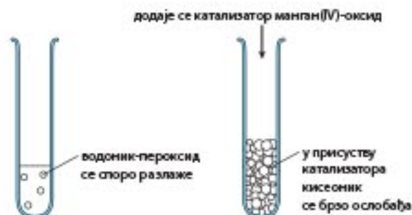
Утицај катализатора манган(IV)-оксида на разлагање водоник-пероксида.
